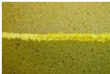
Slechte verlijming (de lijm laag is duidelijk zichtbaar)
